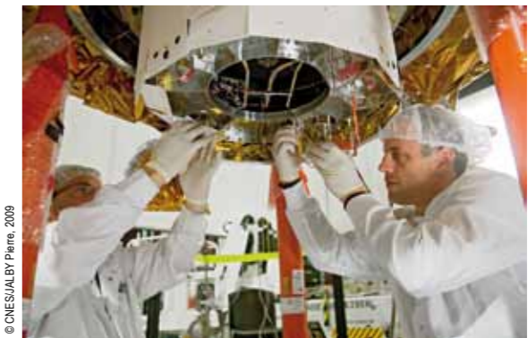
Préparation du satellite Pleiades pour des essais de vide thermique dans le Simmer par les équipes d'intégration et d'essai d'EADS-Astrium chez Intespace.
